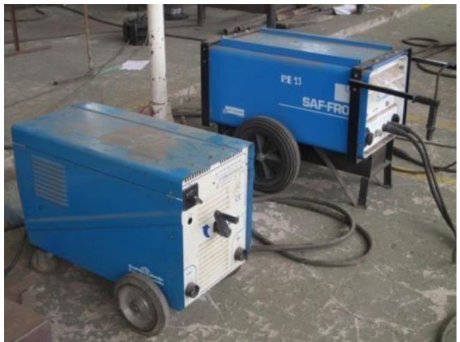
12 Postes à souder électriques
